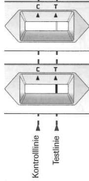
1. Wenn keine Kontrolllinie (C) sichtbar ist, ist das Ergebnis als ungültig zu betrachten. Der Test funktioniert nicht richtig und Sie sollten mit einem neuen Testkit einen neuen Test durchführen.
